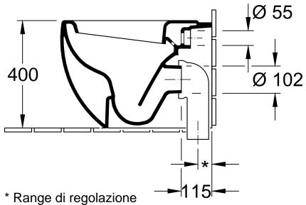
\* Range di regolazione con gomiti WC tradizionali = 70 mm con scarico Vario 8701 = 160 mm
