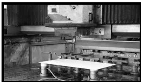
**Fig.24** - SLIMTECH, in tutte le sue tipologie, può essere tagliato anche utilizzando macchine a controllo numerico. La fresa per queste macchine richiede una velocità di rotazione compresa tra 12000 e 18000 rpm, con velocità di avanzamento compresa tra 0,5 e 1 m/min.
