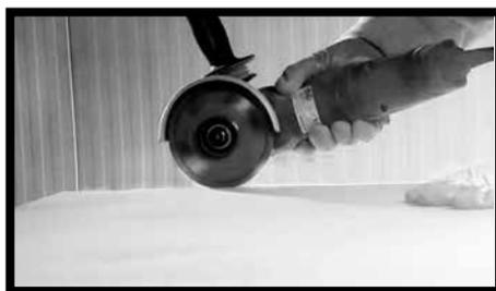
**Fig.21** - È altresì possibile ottenere i medesimi risultati con dischi per carteggiare applicabili alla smerigliatrice manuale.
