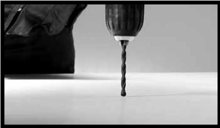
**Fig.16** - Per la foratura manuale si possono utilizzare punte al tungsteno fino ad un diametro di 10 mm montate su trapani elettrici o avvitatori a batteria.
