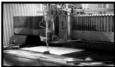
**Fig.25** - SLIMTECH, in tutte le sue tipologie, può essere tagliato anche utilizzando macchine a idrogetto. Raccomandiamo di utilizzare una velocità di operazione compresa tra 2 e 3 m/min.
