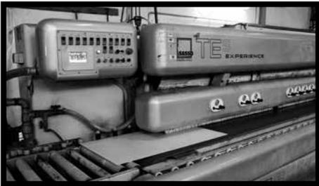
**Fig.28** - Per la formazione e lucidatura del bordo occorre innanzitutto utilizzare mole diamantate e abrasive per ottenere il bordo della richiesta dimensione e forma, quindi si utilizzerà una mola lucidatrice. Si possono ottenere numerose finiture di bordo utilizzando differenti mole. La velocità operativa deve essere testata preventivamente.
