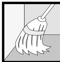
**Fig.36** - La superficie del sottofondo deve essere pulita. Polvere, oli, grassi, sporco e detriti devono essere rimossi in quanto possono compromettere l'adesione del collante.
