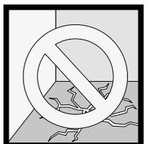
**Fig.37** - Nei massetti a base cementizia la presenza di fessure da ritiro igrometrico è causata da uno o più dei seguenti fattori: eccesso di acqua nell'impasto, aggregato di granulometria troppo fine, eccessivo quantitativo di cemento. Prima di procedere alla posa è necessario sigillare le eventuali fessurazioni.
