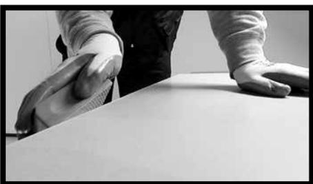
**Fig.20** - Le finiture dei bordi possono essere effettuate a mano tramite l'utilizzo di spugne diamantate o carta vetrata. Con un leggero passaggio sul lato della lastra si può ottenere un effetto rompifilo, oppure con ripetuti passaggi un effetto bisello.
