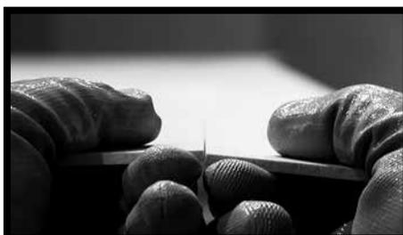
**Fig.11** - Una volta praticata l'incisione è sufficiente una semplice flessione per ottenere il distacco dei due pezzi.
