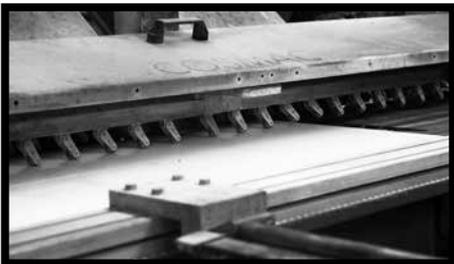
**Fig.29** - Per realizzare un taglio a 45° si possono utilizzare dei dischi diamantati inclinati a 45°. In questo modo è possibile realizzare uno spigolo con due lastre di SLIMTECH, in tutte le sue tipologie. Il nuovo spigolo dovrà essere poi smussato. Si possono ottenere numerose tipologie di finitura di bordo utilizzando differenti mole. La velocità operativa deve essere testata preventivamente.
