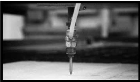
**Fig.27** - SLIMTECH, in tutte le sue tipologie, può essere forato anche utilizzando macchine a idrogetto.
