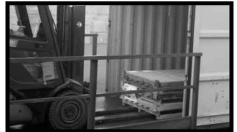
**Fig.8** - Per inforcare il pallet sul lato corto (es. nello scarico dei containers) si dovrà assolutamente utilizzare forche lunghe almeno 2,5 m per una perfetta presa e sollevamento a garanzia dell'integrità del contenuto.
