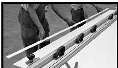
**Fig.13** - Un pratico strumento per eseguire i tagli risulta essere la riga tagliapiastrelle (tipo Keracut della **Sigma** o Free-cut di **Raimondi**). Per SLIMTECH 3plus e SLIMTECH 5plus, anche utilizzando questo strumento, una volta incisa la parte ceramica e spezzata la lastra, si rifinisce il taglio incidendo la fibra di vetro con un normale cutter (**Fig.12**).
