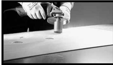
**Fig.17/18** - In alternativa è possibile l'utilizzo di frese a tazza (o foretti) montate su smerigliatrici, trapani elettrici o avvitatori a batteria.
